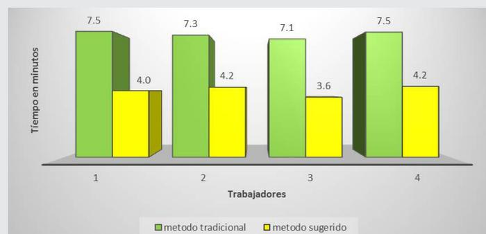
**Figura 4. Compara gráficamente los tiempos resultantes de los desplazamientos para clasificar el producto en las tarimas entre los métodos del estudio.**
